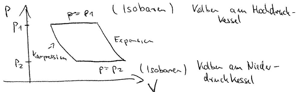
Da die Dampfmaschine nach einem Umlauf wieder am Ausgangspunkt des Indikatordiagramms angekommen ist, kann der Arbeitsbetrag nur auf Kosten der zugeführten Wärme zustande gekommen sein.
